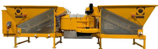
Das Modell F verfügt über vier Zuschlagstoffsilos zur Herstellung von hochwertigem Beton aus ausgewählten Zuschlagstoffen. Die Mobilität der Anlage macht sie für viele Unternehmen zur bevorzugten Lösung bei der Herstellung von Beton direkt auf der Baustelle.
