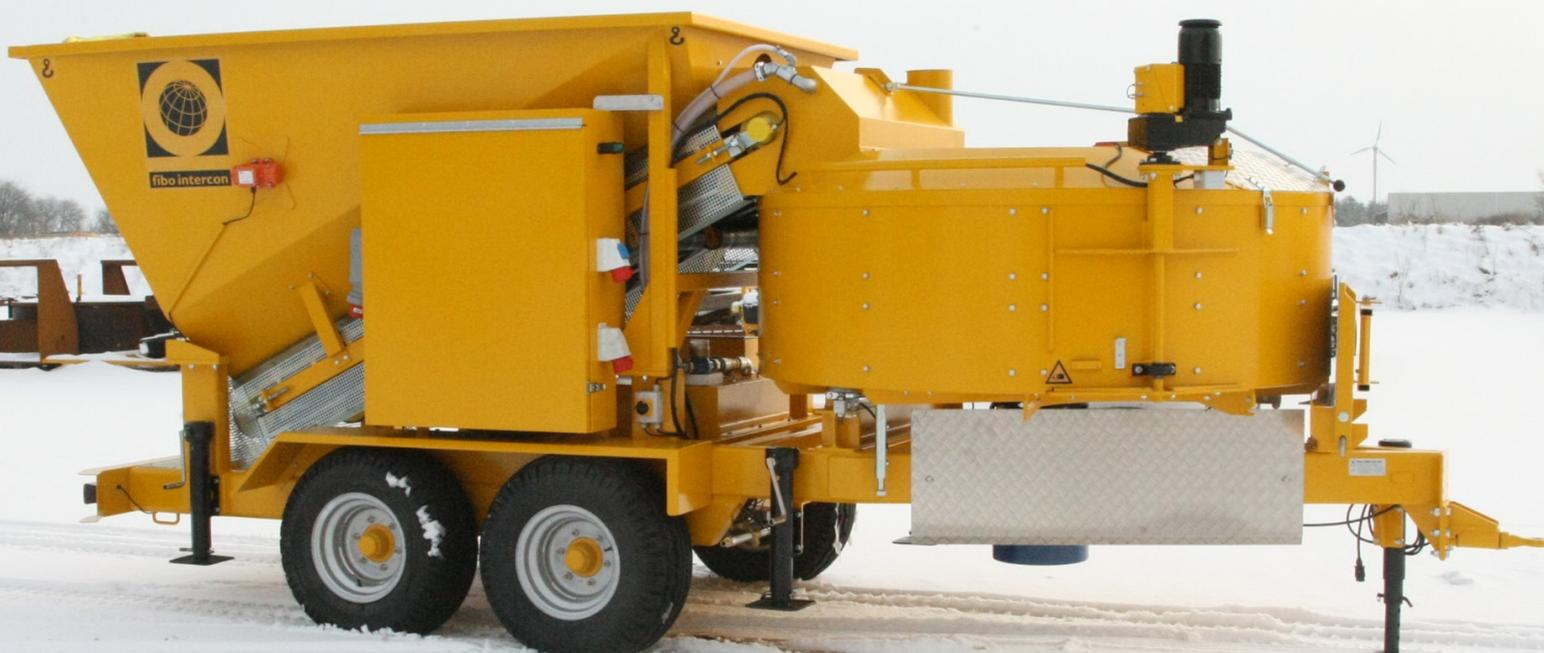
**Vollständig mobile Betonmischanlagen, die auf alle Ihre Bedürfnisse zugeschnitten werden können, mit einer Produktionskapazität für zertifizierten Beton von 3 bis 45m<sup>3</sup> pro Stunde.**
